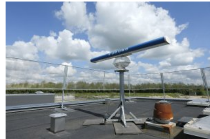
Nedbørsradaren spiller en nøglerolle i den daglige styring af spildevand i Aarhus, da den giver systemet mulighed for at planlægge, ud fra hvor megen regn der falder den næste time. (Foto: Ole Hartmann Schmidt)
